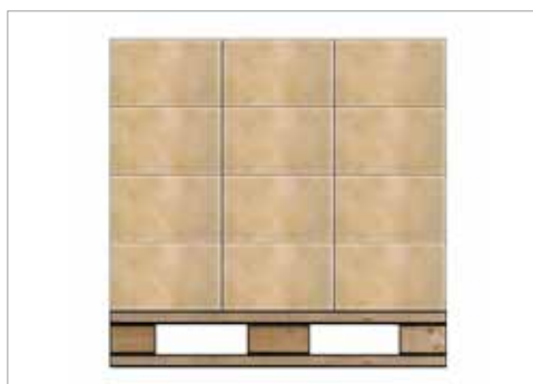
Dimensions identiques à celles de la palette et bon alignement sur cette dernière
