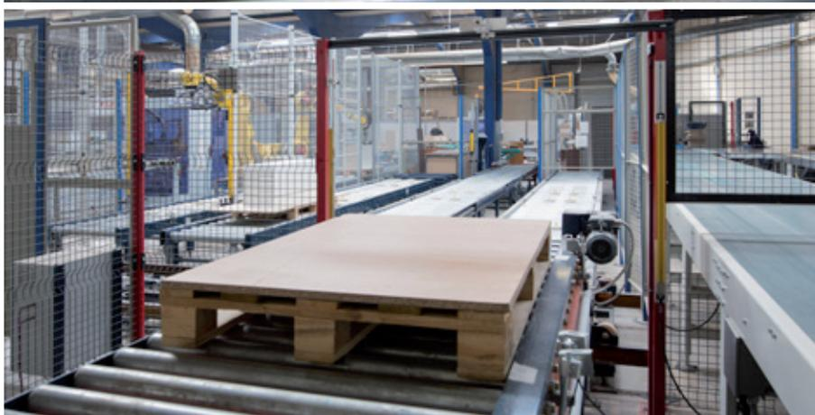
Le centre de production d'Euréquip, fabricant français de mobilier, est doté d'un circuit de convoyeurs des plus avancés. Celui-ci a été fourni par la société Mecalux. La mission principale de ce circuit est de diriger la marchandise vers les différents processus de transformation des panneaux en bois, utilisés pour la fabrication du mobilier. Ce système de transport offre une grande souplesse dans le déplacement de la marchandise vers les postes souhaités.
