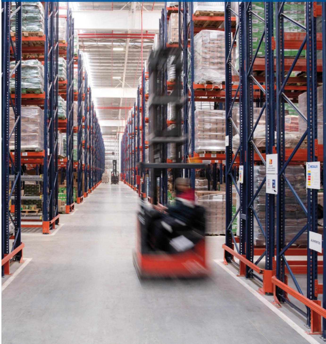
Mecalux a équipé le nouveau centre de distribution d'Unilever à Montevideo (Uruguay) de rayonnages à palettes à simple et double profondeur, offrant une capacité de stockage de plus de 15 000 palettes. De plus, 48 modules de picking dynamique ont été aménagés dans une partie des rayonnages afin d'accélérer la préparation des commandes.
