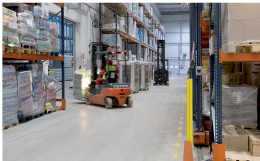
La solution se compose de dix rayonnages doubles de 9 m de haut sur bases mobiles et de six rayonnages fixes de 8,8 m de haut.
