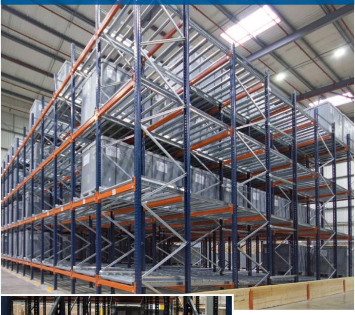
Mecalux a équipé Vaillant, un des leaders du secteur de la climatisation au Royaume-Uni, de rayonnages à palettes dynamiques pour son entrepôt de Belper. Ce système permet d'expédier rapidement les composants nécessaires à l'usine de production. Ainsi, l'entreprise peut maintenir sa croissance constante dans le nord de l'Europe, et renforcer sa position de leader sur le marché mondial.
