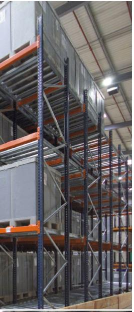
Les rayonnages sont équipés de canaux à rouleaux légèrement inclinés pour permettre le déplacement par gravité des palettes
